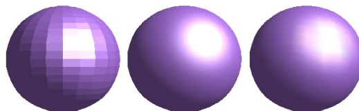
Abbildung 26: Flat-, Phong- und Gouraud- Shading
